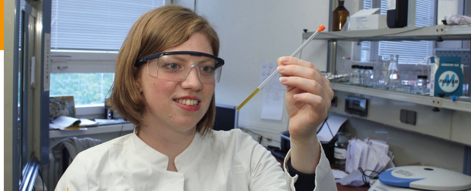
Anna McConnell bereitet eine Probe eines metallorganischen Käfigs für eine Untersuchung mittels NMR-Spektroskopie vor.
