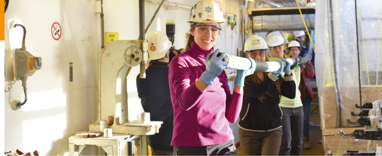
Etwa 10 Meter misst der Sedimentkern vom Meeresboden, den Julia Gottschalk mit Kolleginnen und Kollegen auf dem Bohrschiff Joides Resolution im Südpazifik zur weiteren Bearbeitung und Analyse transportiert.
