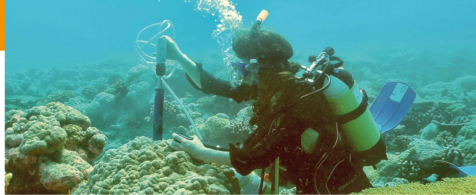
Bei einem Tauchgang im Riff von Diego Garcia, Chagos Archipel (Britisches Territorium im Indischen Ozean) entnimmt Miriam Pfeiffer einer Steinkoralle einen Bohrkern.
