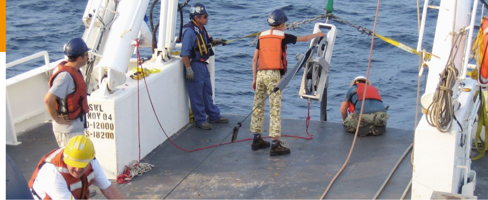
Inga Koszalka beim Sichern einer Winde, die eine Kette mit Temperatursensoren an Bord eines Schiffes (R/V Endeavour) holt (New Jersey Shelf, USA, August 2006)
