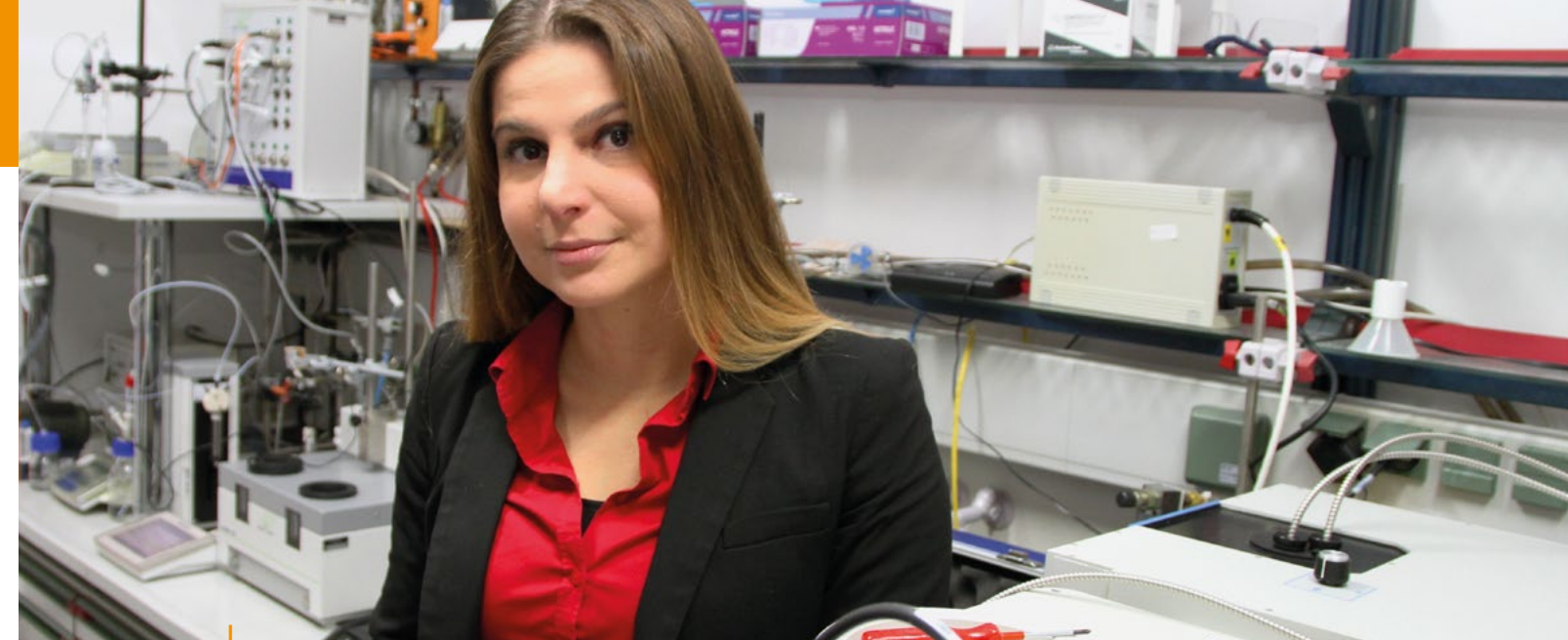
Huayna Terraschke untersucht mit dem Fluoreszenzspektrometer (rechts vorne) die optischen Eigenschaften von leuchtenden Nanopartikeln.
